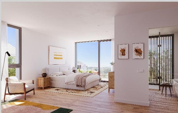
El pavimento interior de la vivienda en gres porcelánico imitación madera, garantizará la transmisión de calor proveniente del sistema de suelo radiante, asegurando el confort en el interior de todas las estancias.
